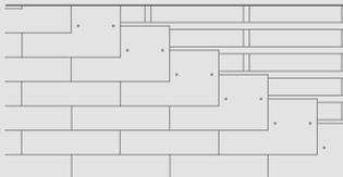
Pose inclinée à recouvrement double
